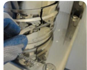
3. Klemmband über die Sicke schließen und kraftschlüssig verschrauben.
